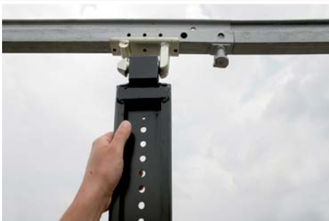
Edscha TS Topkupplung Edscha TS top coupling
