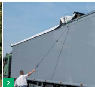
Öffnungsvorgang, Ein-Mann-Bedienung vom Boden aus Opening procedure, one-man operation from the ground
