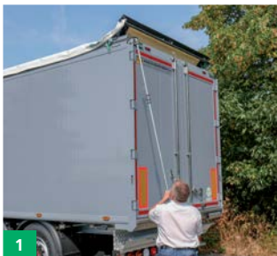
Öffnungsvorgang, Ein-Mann-Bedienung vom Boden aus Opening procedure, one-man operation from the ground
