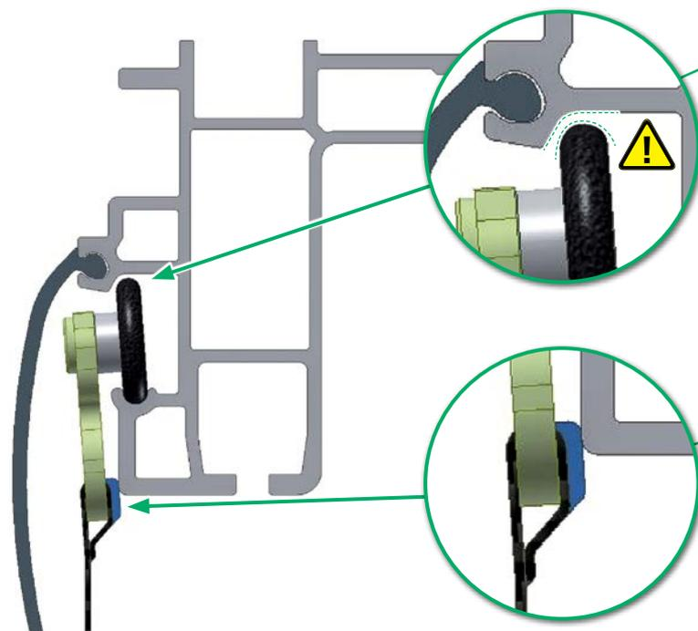
1 Die Unterfütterung des Planengurtes muss so ausgeführt werden, dass der Kontakt zwischen der Planenroller-Laufrolle und der Laufkammerbegrenzung im Laufschieneprofil verhindert wird.
